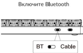
Зажмите fn + 1 (в течение 4 секунд) и выполните сопряжение с устройством с именем Keychron K7.
