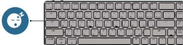
Зажмите fn + S + O (в течение 4 секунд), чтобы отключить автоматический спящий режим.
